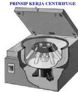
Centrifuge adalah alat untuk memutar sampel pada kecepatan tinggi, memaksa partikel yang lebih berat terkumpul ke dasar tabung centrifuge. Pemakaian centrifuge yang paling sering adalah untuk pemisahan komponen sel darah dari cairannya sehingga cairannya bisa dipakai untuk pemeriksaan.
